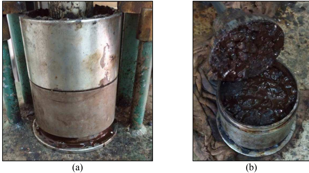
Figura 4.3 - (a) Exsudação do material betuminoso na base do molde no momento da compactação; (b) aspecto do corpo de prova após a compactação
