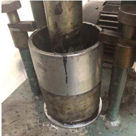
Figura 2.4 - Exsudação do material betuminoso na base do molde no momento da compactação
