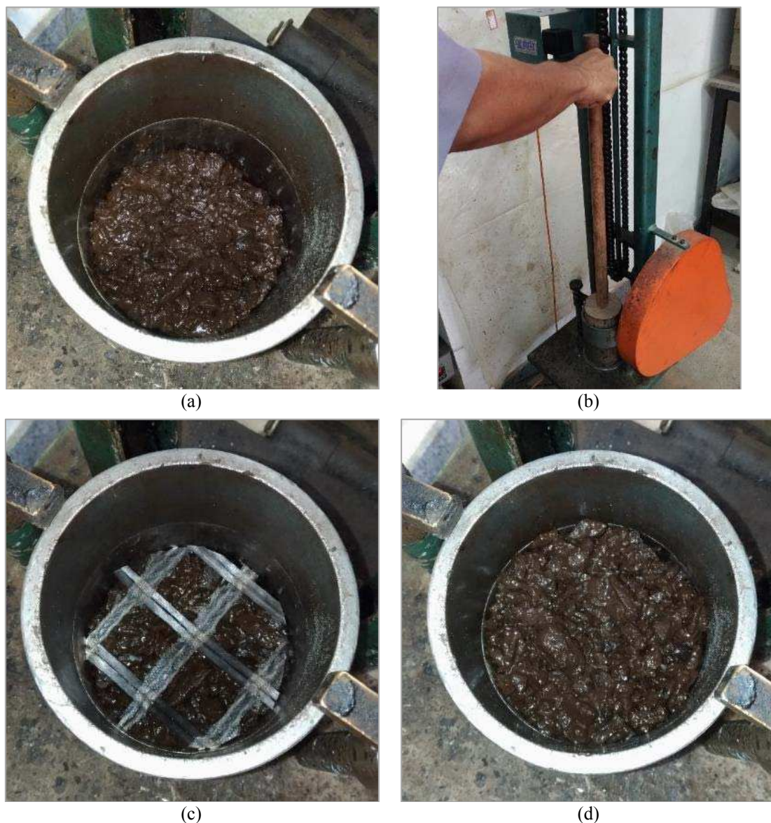
Figura 3.1 - Ilustração das etapas da produção dos corpos de prova reforçados pela geogrelha: (a) disposição da primeira metade (em massa) da mistura asfáltica; (b) regularização da camada com um soquete de madeira; (c) inserção da geogrelha; (d) disposição do restante da mistura asfáltica
