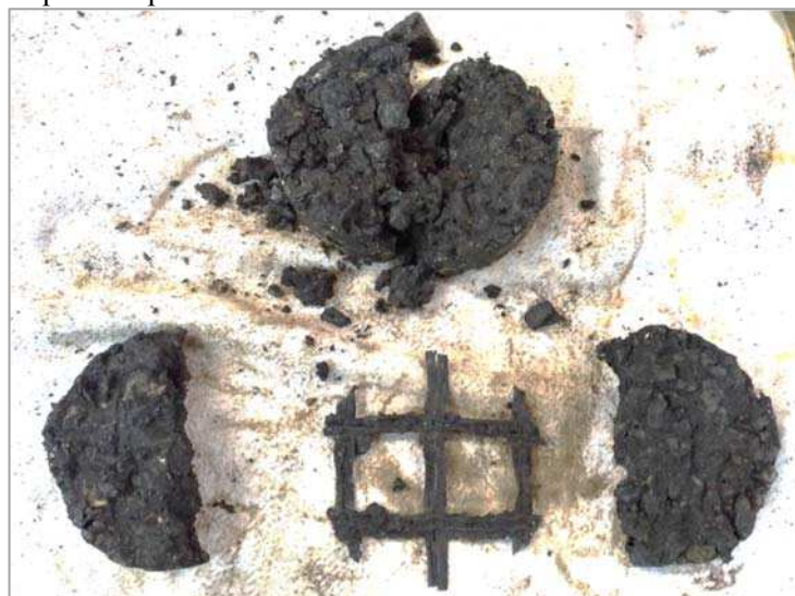
Figura 3.6 - Exumação da geogrelha em um corpo de prova após a realização do ensaio de resistência à tração por compressão diametral
