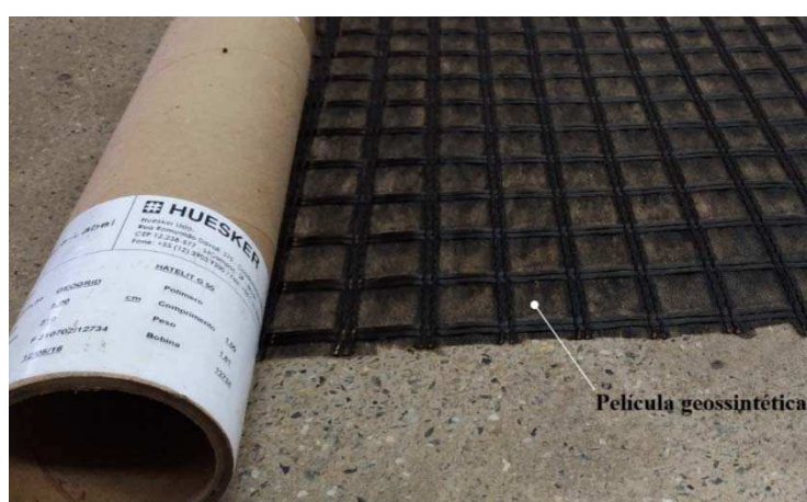
Figura 3.7 - Reforço geossintético HaTelit® G 50 utilizado na pesquisa, destacando a película geossintética
