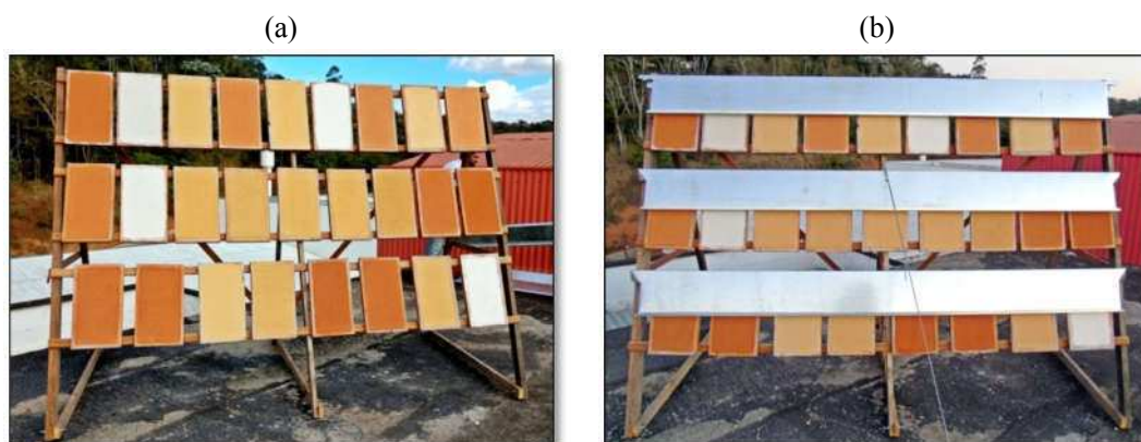
Figura 1.7- Ensaio de resistência ao intemperismo das amostras de tinta: a) antes da fixação da chapa metálica; b) depois da fixação da chapa metálica.
