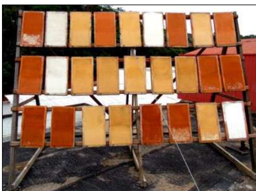
Figura 1.21- Resultado do ensaio de resistência ao intemperismo das amostras de tintas após seis meses de exposição.
