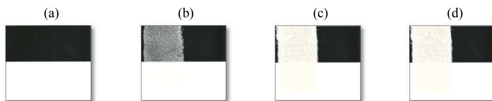
Figura 1.5- Aplicação da tinta de resíduo de granito sobre a cartela BYK ref. PA 2811: a) Nenhuma demão; b) Uma demão; c) Duas demãos; d) Três demãos.
