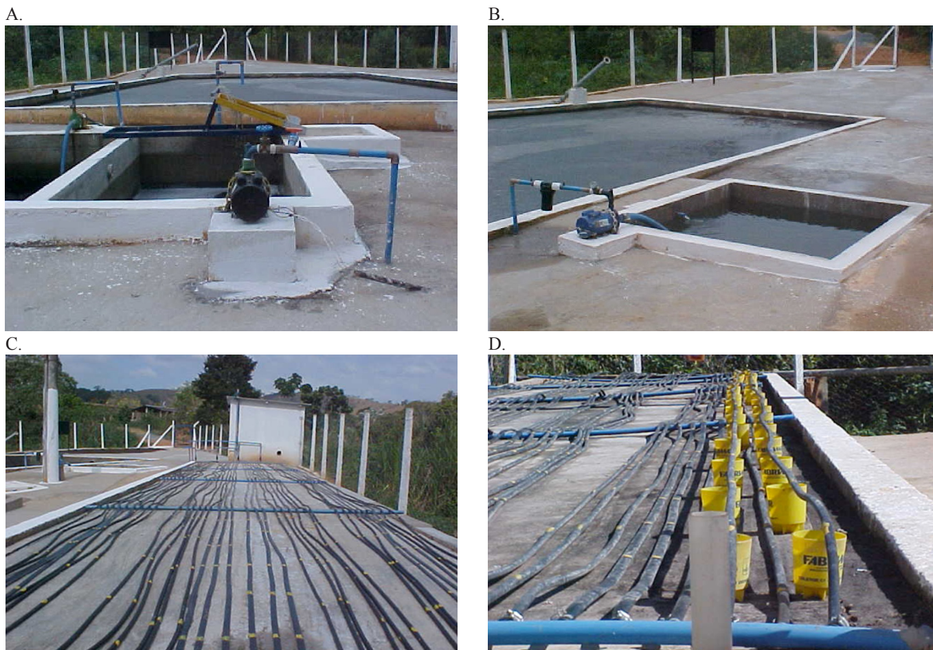
Figura 1. Bancada experimental destacando-se as unidades de controle para bombeamento de água residuária de suinocultura (A), a água de abastecimento (B), a plataforma de testes (C) e o ensaio para medição de vazão (D)
