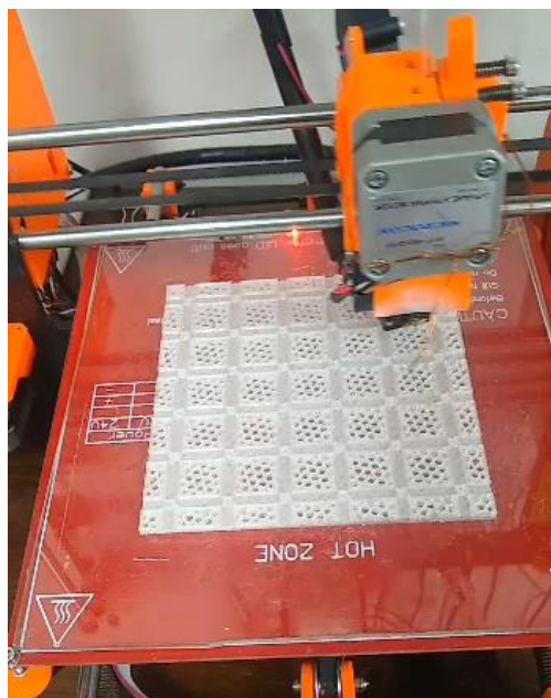
Figura 34 – Imagem da reprodução do produto pela impressora 3D
