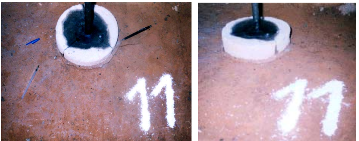
Figura 3.9 – Detalhe do soerguimento do solo junto à estaca
