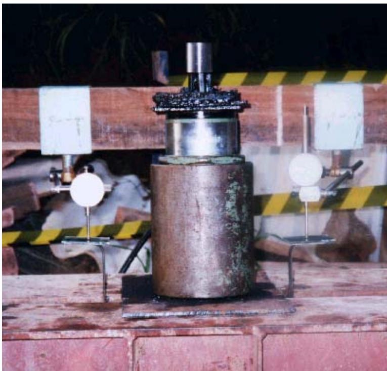
Figura 3.7 – Travamento do êmbolo do macaco hidráulico e disposição dos extensômetros
