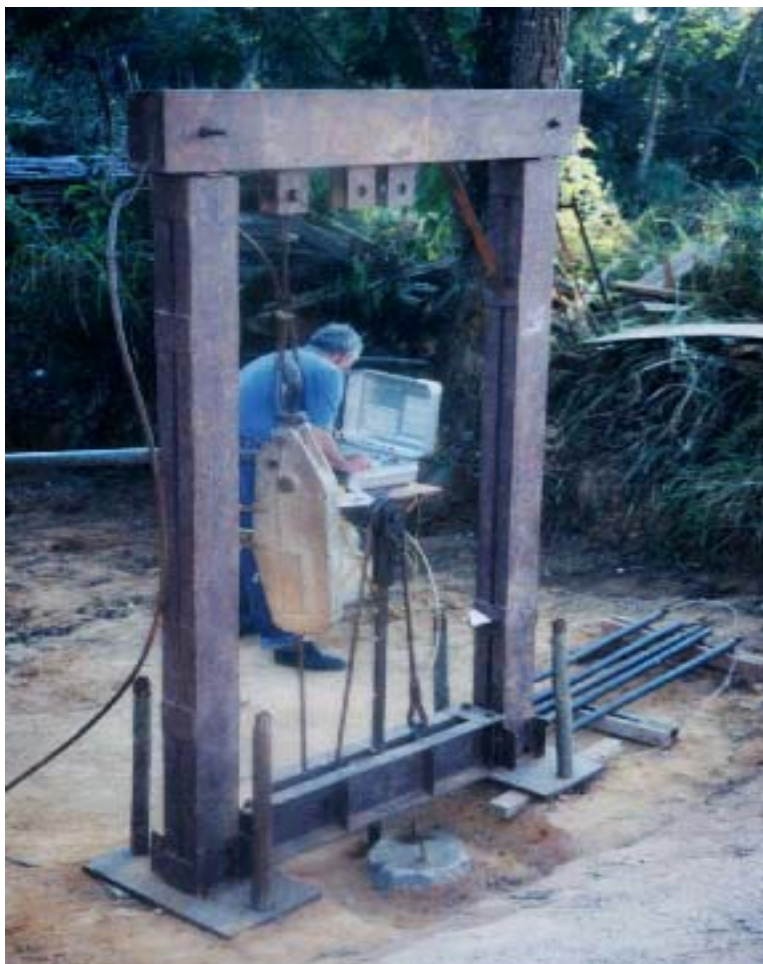
Figura 2.9 – Sistema de reação e inserção da lâmina dilatométrica
