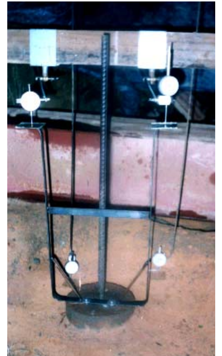
Figura 3.7 – Travamento do êmbolo do macaco hidráulico e disposição dos extensômetros
