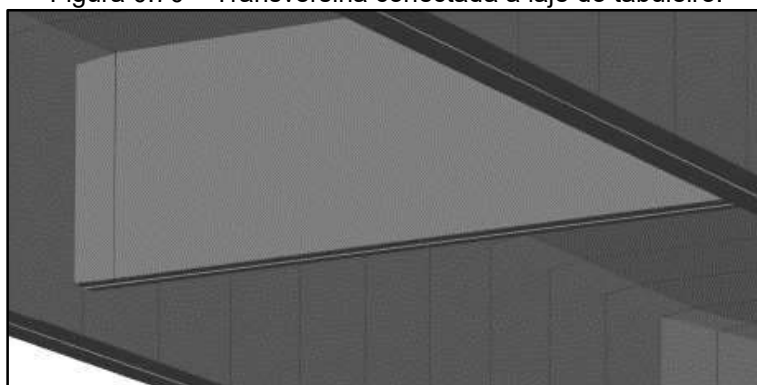
Figura 0.70 – Transversina conectada à laje do tabuleiro.
