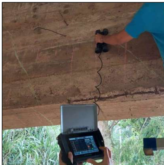
Figura 4.7 – Realização do ensaio de pacometria em uma das longarinas da Ponte sobre o Ribeirão Teixeiras.
