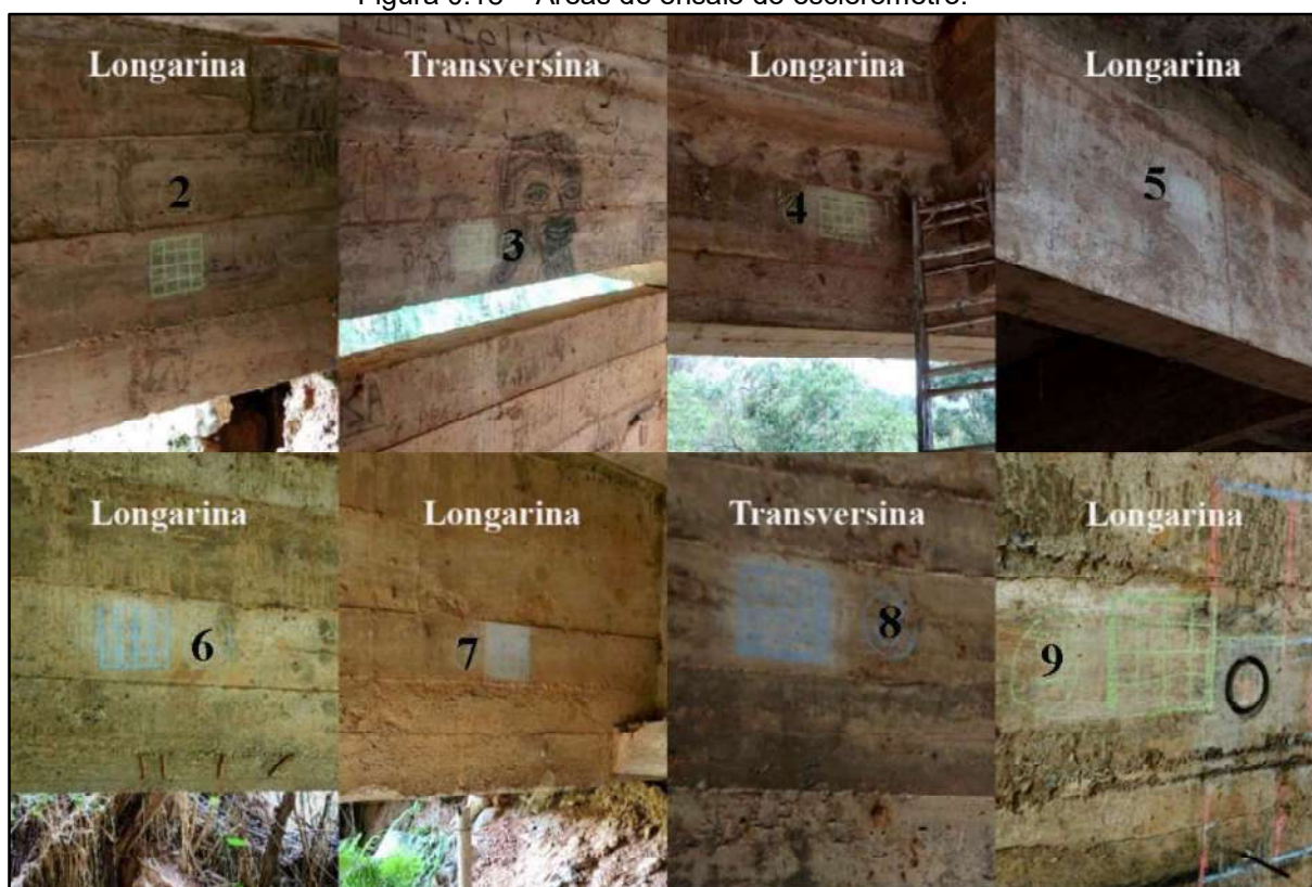
Figura 0.18 – Áreas de ensaio do esclerômetro.
