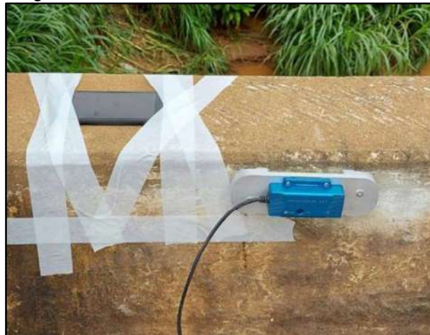
Figura 4.13 – Acelerômetros fixados na defesa.
