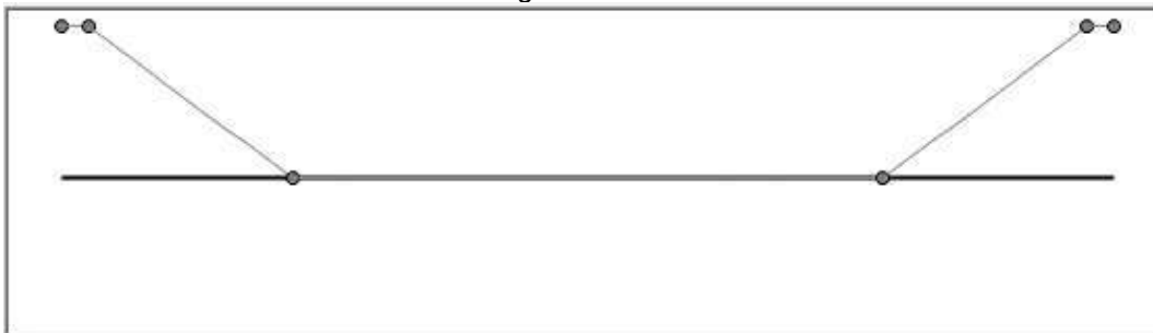
B - Esquemática do engrossamento nos vãos centrais Fonte: O autor.
