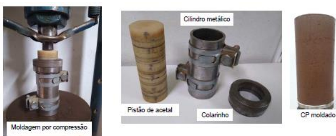
Figura 24 – Detalhe da moldagem dos corpos de prova para os ensaios CIU SAT
