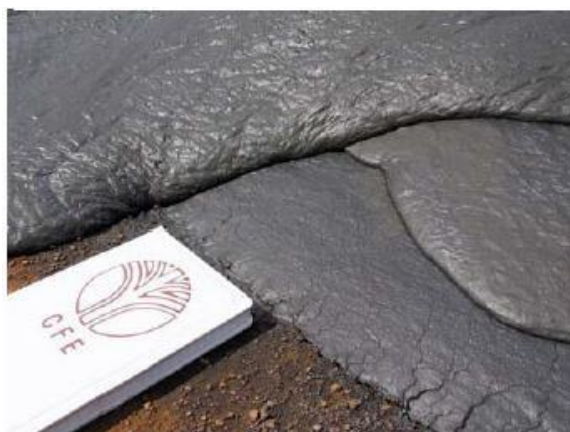
Figura 13 – Detalhes da disposição de pasta em torres, formando três finas camadas sobrepostas
