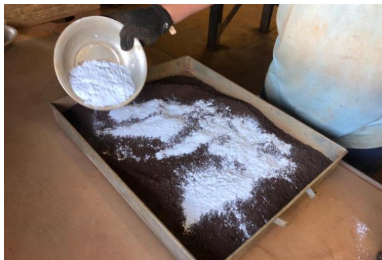
Figura 21 – Uso de cal hidratada para estabilização química dos rejeitos
