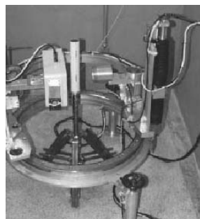
Figura 2. Vista geral do tomógrafo utilizado para determinação da densidade média do solo. Fonte: Naime (2001).
