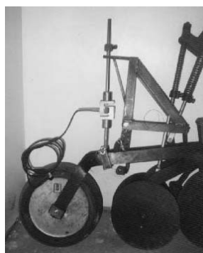
Figura 1. Vista geral dos equipamentos utilizados na determinação das cargas aplicadas no solo pela roda compactadora: (1) célula de carga, (2) visor.
