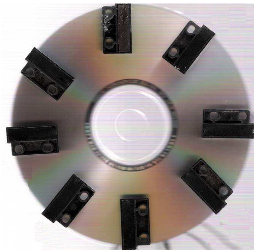
Figura 3A - Montagem dos ímãs em disco para o sensor de direção do vento.
