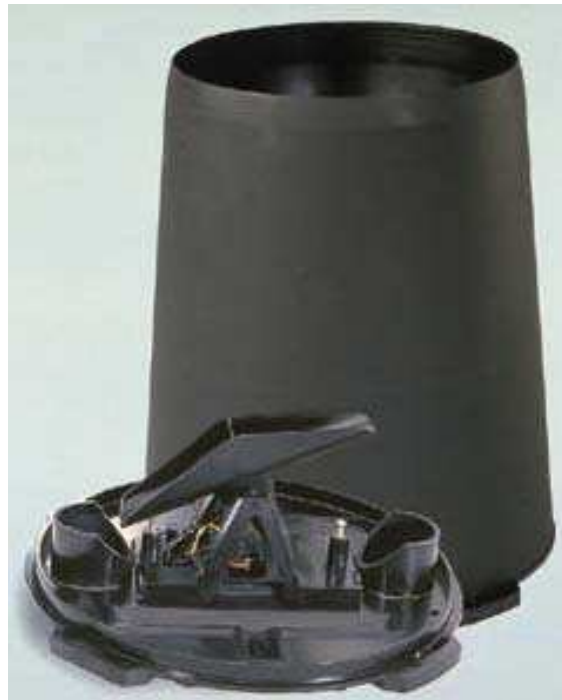
Figura 26- Conjunto com reservatório reclinável para medição de precipitação pluviométrica e o coletor de chuva.
